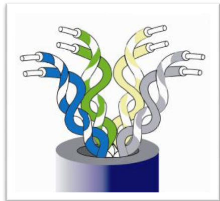
1. Przewód typu "skrętka"
